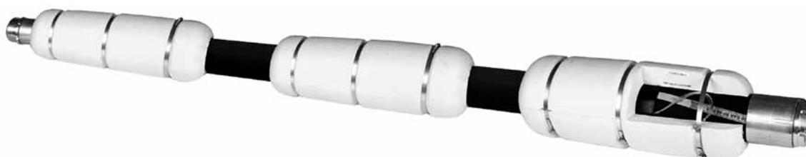
Состоят из шланга и буйков, закрепленных по всей длине шланга. Легкость и яркие цвета служат для плавания и хорошей видимости. Буйки крепятся к шлангам с помощью обжимов, а тросик предохраняет от смещения буйков по длине шланга. Для такого решения можно применять резиновые рукава на пример FUEL HARDWALL, FUEL SOFTWALL, POTABLE и буйки.
