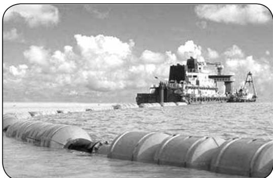
Плавающие шланги имеют широкое применение при ин-сталляциях на воде. Чаще всего используются при пере-грузке нефти в портах, перекачка сырой нефти между вышкой и танкером, углубление подводных труб, итд. Благодаря разным техническим решениям шланги удерживаются на поверхности воды, что предохраняет их от повреждений винтами кораблей и упрощает маневрирование судов Плавающие шланги также лучше видны при тяжелых погодных условиях. Изготовлены из ненамокающей и нетонущей пенки.
